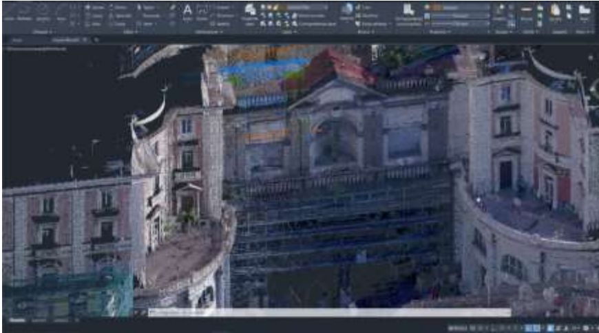
Figura 6 - Importazione della nuvola di punti in ambiente CAD
